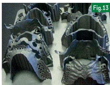
Fig.13 : Châssis pour PAPM imprimés par frittage Laser.
