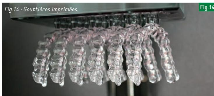
Fig.14 : Gouttières imprimées.
