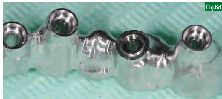
Fig.6c : Modélisation numérique de l'armature. Fig.6d : Armature fraisée avec trois émergences implantaires différentes. Fig.6e : Précision du joint armature / implant. Fig.6f : Détail de l'intrados de l'armature. Fig.6g : Contrôle radiologique de la précision et de la passivité du bridge.
