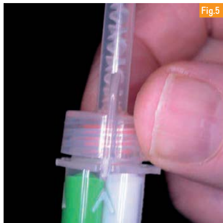
Fig.5 : Afin de stocker la seringue remplie, il faut tourner l'embout mélangeur jusqu'au chevron.
