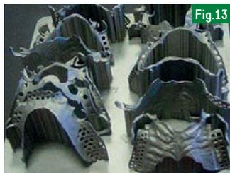
Fig.13 : Châssis pour PAM imprimés par frittage Laser.
