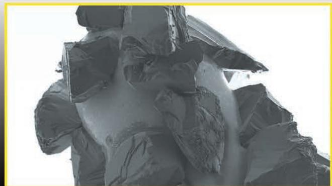
La couverture uniforme et la liaison durable permettent le perçage très efficace des matériaux durs.
