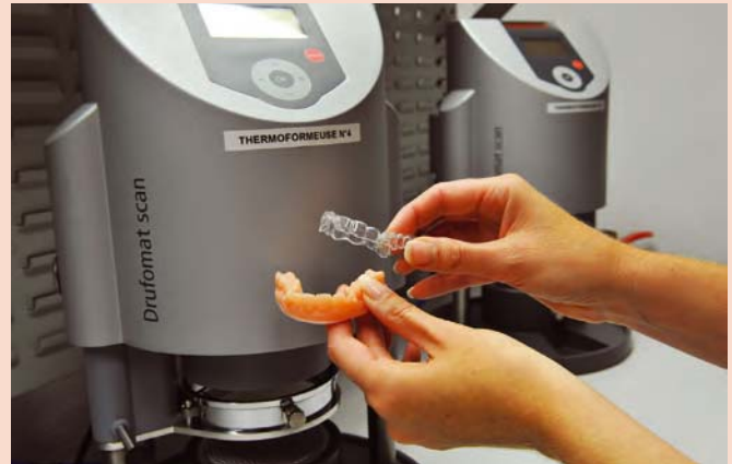
Thermoformage de gouttières transparentes DentoSmile
