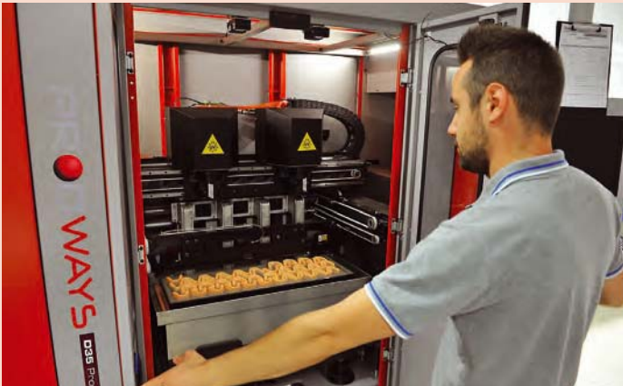
Fabrication d'un lot de modèles par stéréolithographie
