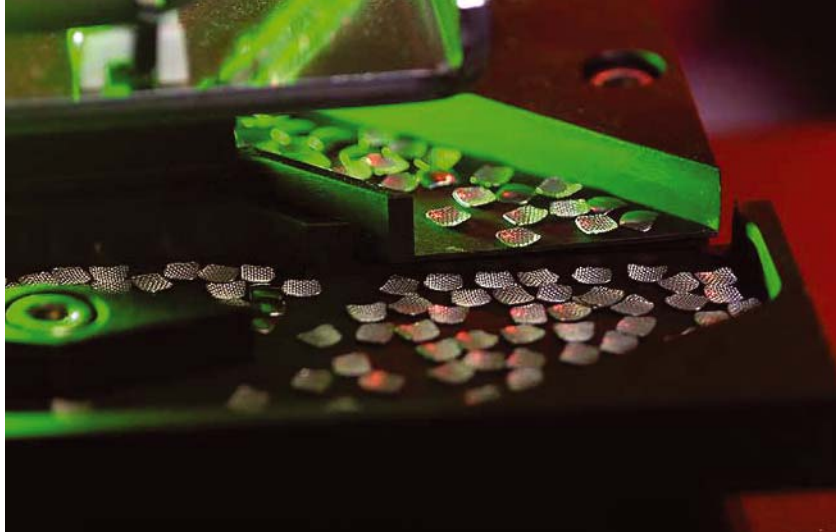
À l'usine de Sarasota, une partie de la chaîne de fabrication des brackets
